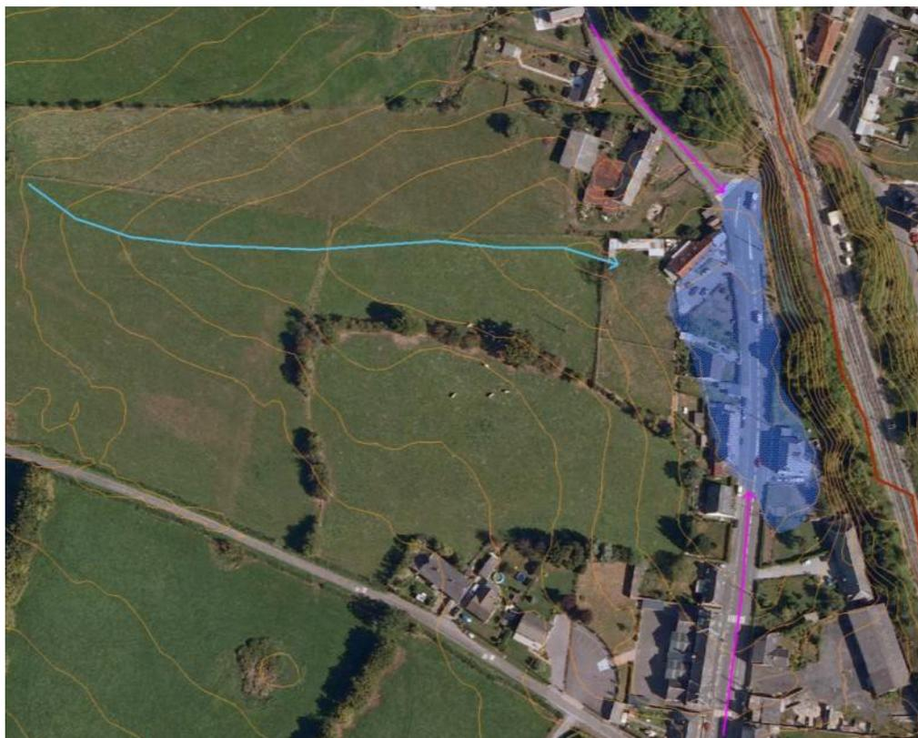
**Figure 14** : Extrait de la cartographie du ruissellement urbain ( flèches roses ) le long des axes routiers potentiellement exposés et zone d'accumulation (en bleu) à Anor [Source : IMS<sub>RN</sub>]
