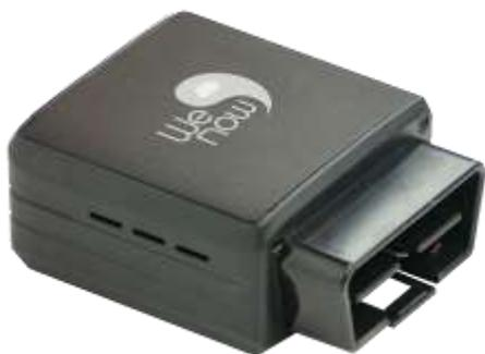
Branché sur la prise OBD (On-Board-Diagnostic) du véhicule, le boîtier WeNow permet de collecter en temps réel les données du trajet du conducteur (kilométrage, accélérations, décélérations, vitesse, quantité de CO<sub>2</sub> émis, consommation de carburant...). En fin de trajet, ces données remontent sur l'application mobile WeNow, que le conducteur peut consulter.
